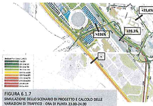
Figura 1: simulazione dello scenario di progetto e calcolo della variazioni di traffico ore 23:00-24:00. Fonte: Figura 6.1.7 - Studio preliminare della viabilità di progetto
